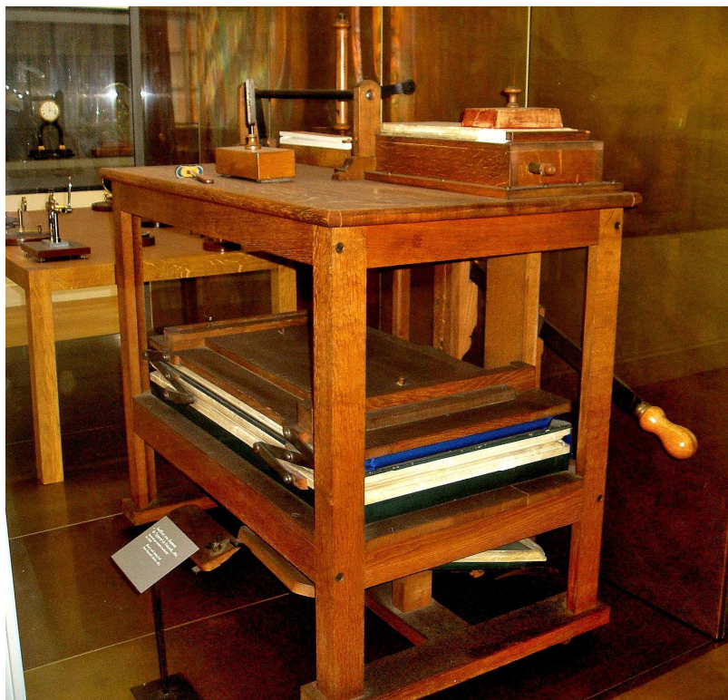
Fig. 4- El fuelle de Cavallé-Col (Museo de Artes y Oficios, París) que alimenta la turbina del espejo giratorio.
