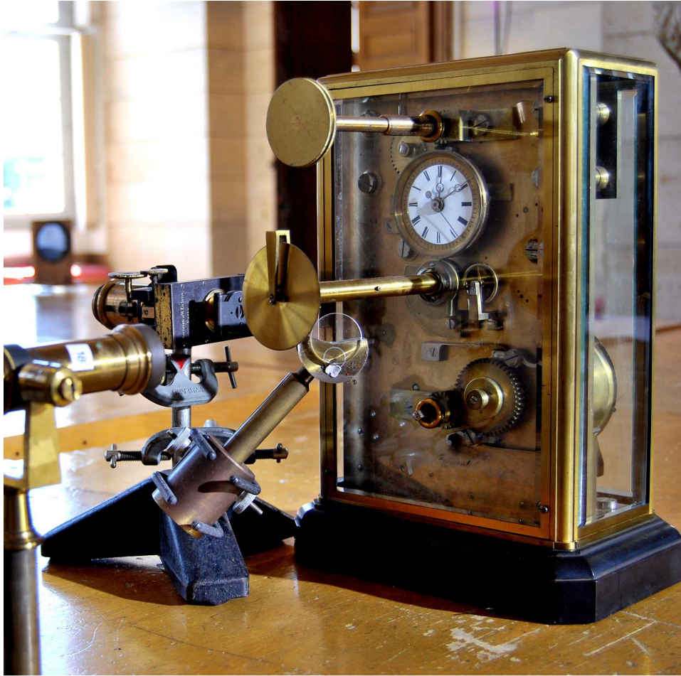
Fig. 5- El reloj estroboscópico. El reloj arrastra un disco dentado (delante) que permite la medida de la velocidad de rotación del espejo por efecto estroboscópico.
